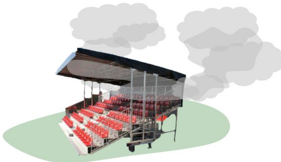
Figur 2 Eksempel på åben konstruktion, hvor røgen ikke kan ophobe sig og derfor ledes væk
